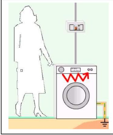
5- نطرح آلة غسل ثياب بهيكل معدني مرتبطة بشبكة التيار الكهربائي. نفترض أن الأسلاك الناقلة للتيار تأكلت بفعل القدم والاستعمال إلى حدّ حصول تسرب ( وهو مرور التيار الكهربائي في المسار الغير مقرر له ).
